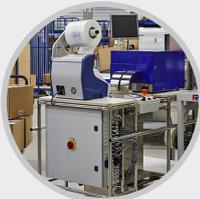
**Cutting Device:** Die Schneidevorrichtung ist ein Accessoire, welches produzierte Luftkissen in separate Stränge teilen kann.
